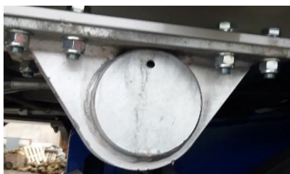
ložisko navárateľné hliníkové
