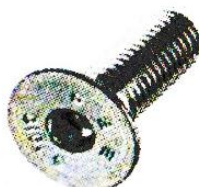
zápustná skrutka M10x30, klasifikácia 10.9, pozinkovaná
